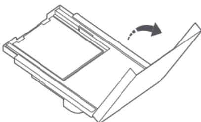
**4** Vložte 3" samolepicí fotopapír do slotu 3" držáku papíru lesklou stranou nahoru.
